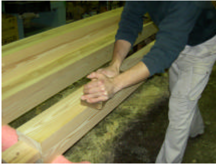
↑ 鉋 (かな) は柱の表面を削り滑らかにします
