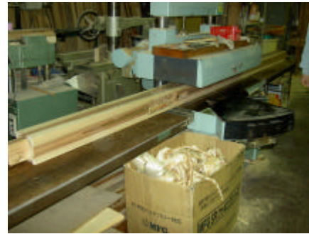
↑ 超仕上鉋盤 (ちょうしあげかなばん) は柱や梁や桁などの凹凸やムラを取り手で削るのを機械で仕上げます
